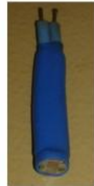
Sensoren monteret med krympeflex.
